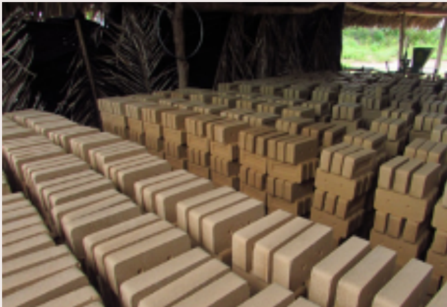
Figura 8 – Tijolos de solo-cimento produzidos em uma das aldeias. Fonte: Acervo do projeto Kikré.
