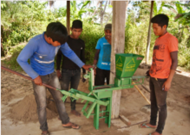
Figura 7 – Aprendendo a usar a prensa de tijolos de solo-cimento. Fonte: Acervo do projeto Kikré.
