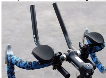
Figura13: Guidão de bicicleta de ciclismo com clips e pads para contra relógio e triathlon.
