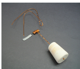
Figura 3. Fio de cobre contendo a fita de magnésio, fixado a uma rolha.
