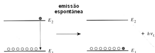
Figura 6 - Uma ilustração do processo de emissão espontânea. Luz com energia h\nu_{12} = E_2 - E_1 pode ser emitida espontaneamente quando um átomo passa de um estado excitado para o estado fundamental.
