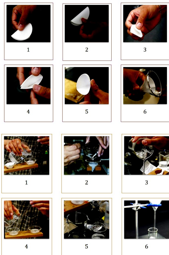
Figura 5. Procedimentos passo a passo, a serem observados em uma filtração por gravidade. No primeiro bloco se mostra como dobrar o papel de filtro e no segundo bloco, a técnica de filtração [14,15].
