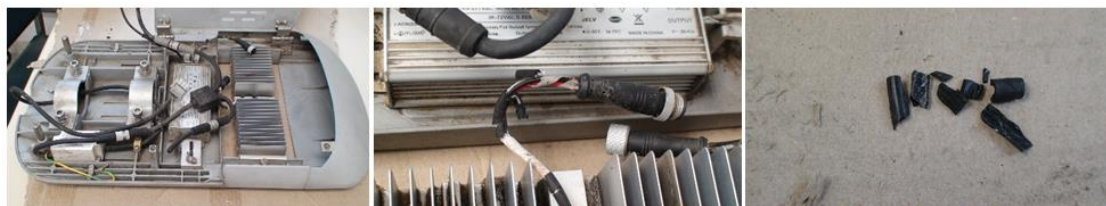
Figura 2 – Imagens de uma luminária da CUASO (identificação, ID 12019), à esquerda vista interna ampla, no meio o cabo de ligação do módulo LED, à direita fragmentos destacados do cabo de ligação, data das fotos: 28/abr./2023.
