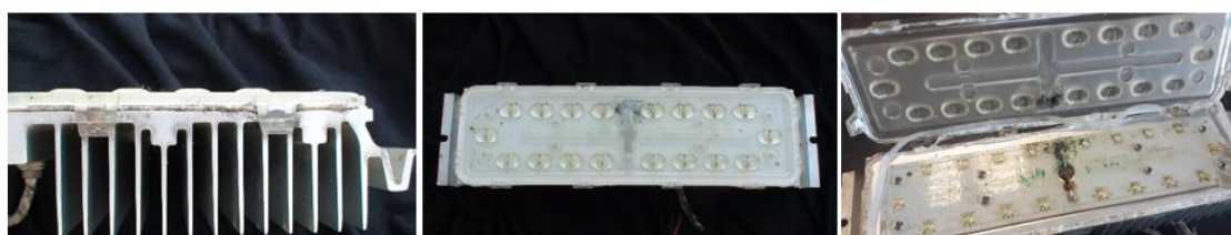
Figura 3 – Imagens produzidas a partir de um módulo LED (identificação: HPB4028LZ1; LD-18-T; V1.06; 2013-5-17; 4.000K) retirado da luminária CUASO (identificação, ID 1151), à esquerda, vista lateral (lente na parte superior), no meio a vista frontal (LED – lado da lente), à direita o módulo LED após aberto e a lente removida (lado superior), data das fotos: 08/maio/2023.
